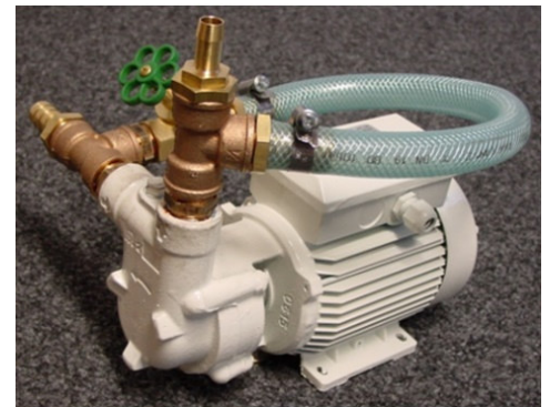
Pumpe C-80 mit Bypass- und manueller Drosselung
