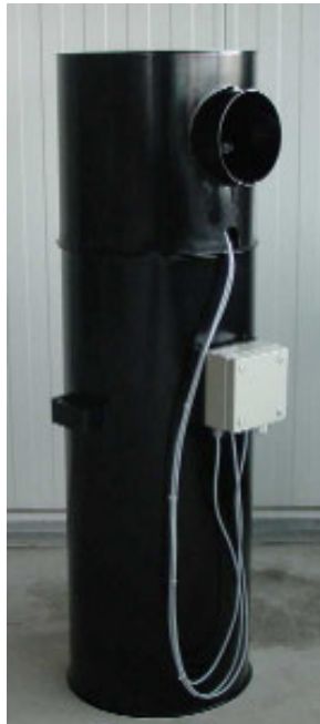
Abb.: Mischersaugentlüftung Gr. VII 7,5 m 2
