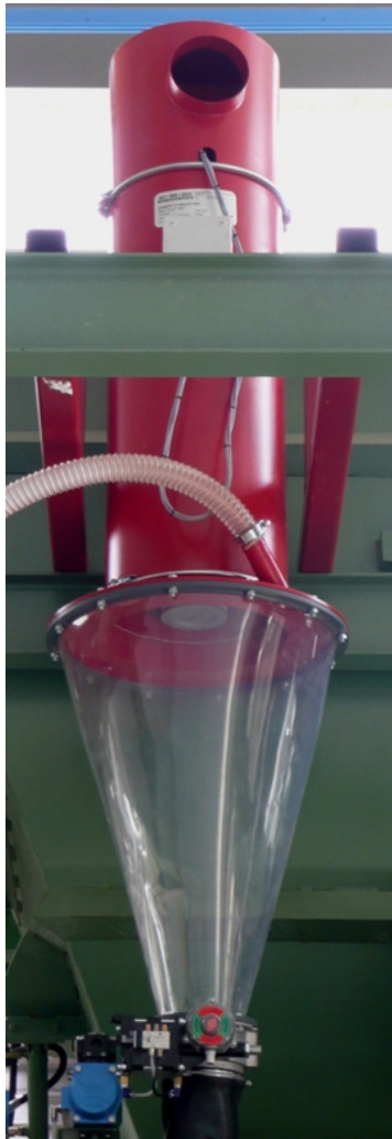
Pigmentabscheider Gr. VII 7,5 m 2 , V= 100 l
