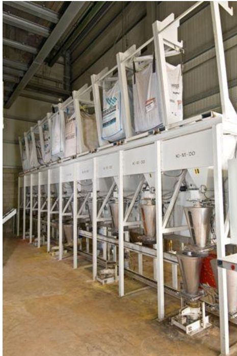
PFW 10 mit 2 Fahrwerken zur Entleerung auf 7 Fallrohren zur Aufgabe auf 7 Beschickeraufzüge (Fallrohre schwenkbar und gleichzeitig Pufferbehälter)
