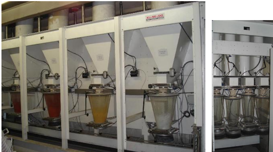
PF 6 und PF 4 S für Sackbefüllung mit Fahrwerk zur Entleerung auf eine Zuschlagwaage
