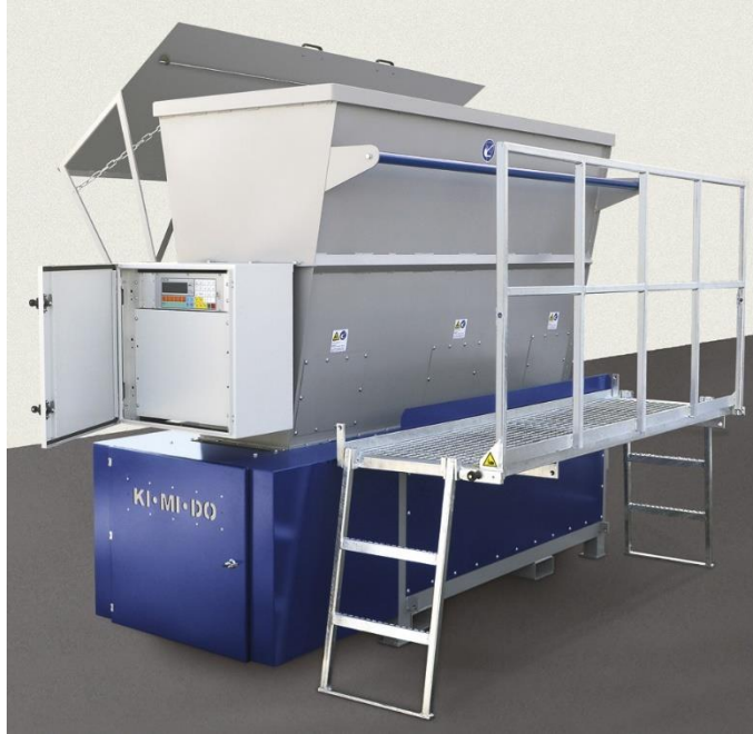
Mobile Lösung: FS 1700/400 mit Laufsteg und Dosiersteuerung DS 4
