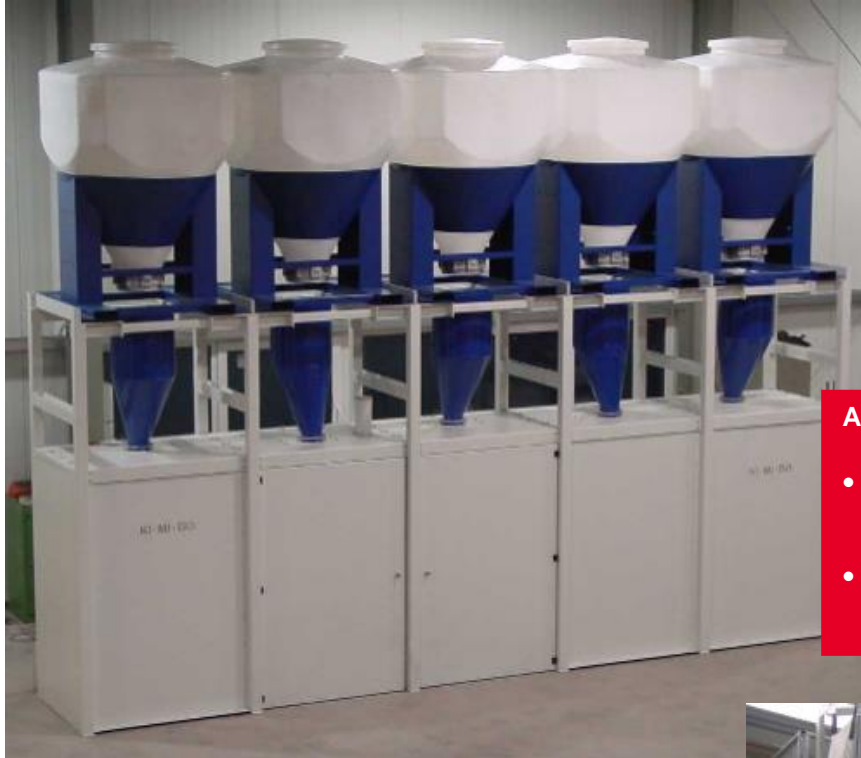
FD 5 DS mit Sonderausstattung PVC-Silos 1,2 m³
